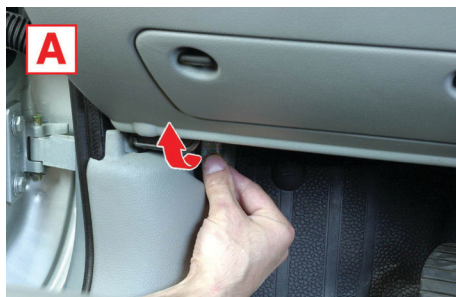
◀ Levier de déverrouillage intérieur du capot moteur. ▶
