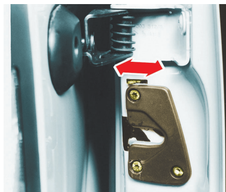
Sécurité enfants de verrouillage des portes arrière.
