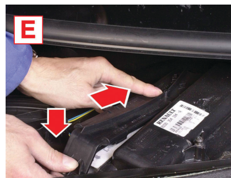
Remplacement du filtre à air d'habitacle.
