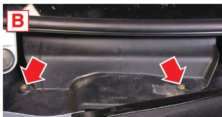
Remplacement du filtre à air d'habitacle.
