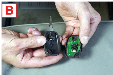
▲ Dépose de la pile.
